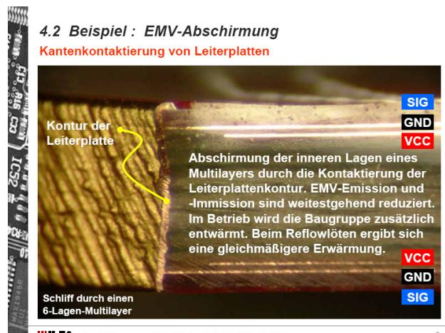
Auch MultiPowerSysteme haben einen positiven Einfluß auf das EMV-Verhalten einer Baugruppe. Anscheinend wird durch die gestapelten Powerplanes Störenergie besonders intensiv in Wärmeenergie umgewandelt und auf diese Art dem Störkreislauf entzogen.
