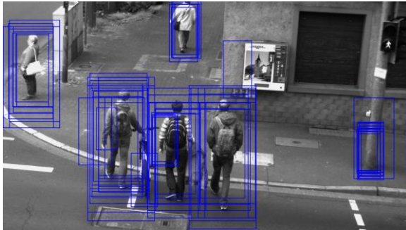
Abbildung 4: SVM-Klassifikationen mehrerer Skalenstufen
