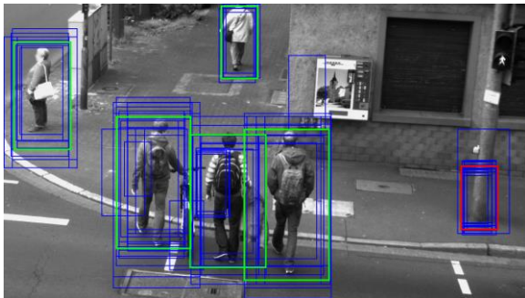
Abbildung 3: SVM-Klassifikationen mit fusionierten Detektionsergebnissen
