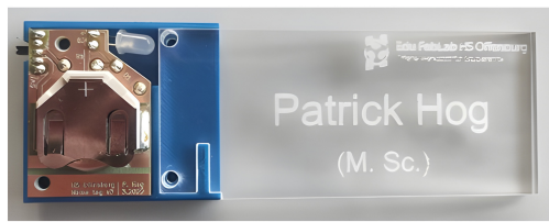
A) Alte Variante Namensschild mit Leiterkarte, Batteriehalter, Widerstand...
