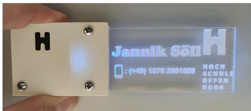
C) Neue Variante Namensschild mit integrierten gedruckten Leitungen, Widerständen...
