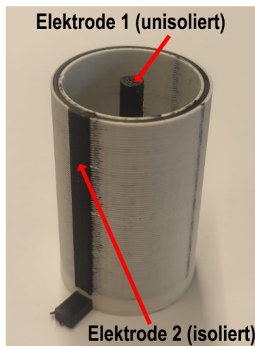
Abbildung 11. Realisierter Füllstandssensor im 3D-Druck. Die Messsonde entspricht Elektrode 1. Elektrode 2 ist in den zylindrischen Messbehälter integriert.
