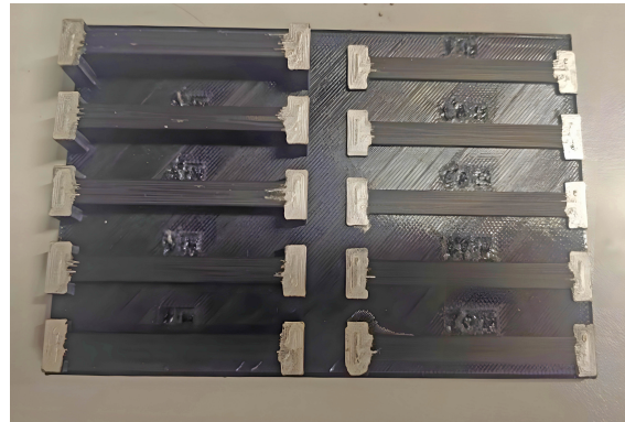
Abbildung 5. Proben zur Messung des Widerstandes in X-Richtung.
