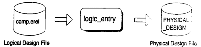
Abb. 3 ES2_LOGIC_ENTRY wandelt die logischen, expandierten Daten eines Design in physikalische Daten um.
