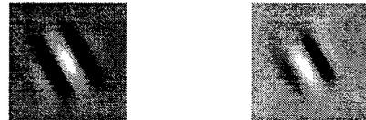
Abbildung 1: Realteil (links) und Imaginärteil (rechts) eines Gaborfilters.
