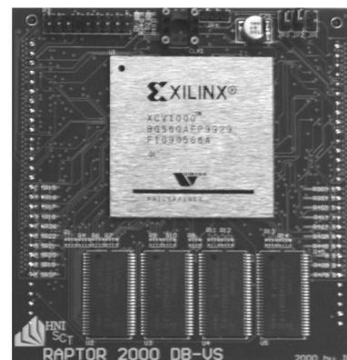
Abbildung 5: Der Hardware-Prototyp umfasst einen Xilinx FPGA der VirtexE-Serie und 4 SDRAM-Speicherchips, die insgesamt 128 MB über einen 32 bit-Datenbus bei 100 MHz Taktfrequenz erreichbar machen.
