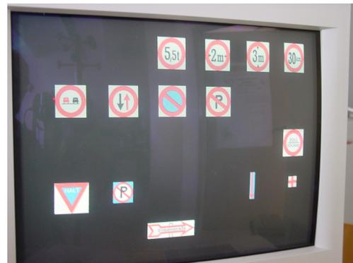
Abbildung 16: Foto der Bildausgabe am Monitor, wenn der CCL-Algorithmus nur rote, Verkehrszeichen selektiert
