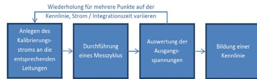
Abbildung 13: Erstellung einer Kennlinie zur Steigerung der Genauigkeit.
