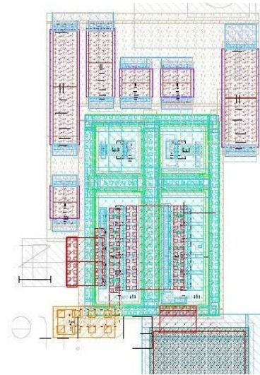
Abbildung 3: Layout der ersten Verstärkerstufe (Ausschnitt).
