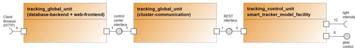
Abbildung 8: Das Kompositionsstrukturdiagramm nach UML 2.0 zeigt den Systemaufbau der Smart Tracker-Modellanlage. Links befinden sich die Schnittstellen zu den Client Tiers. Die beiden Module der Tracking Global Unit (TGU) bilden die Cloud-basierten Tiers und die Tracking Control Unit (TCU) stellt den Embedded Tier dar.
