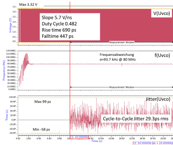
Abbildung 5: Simulation von U_{VCO} mit 80 MHz Taktfrequenz.
