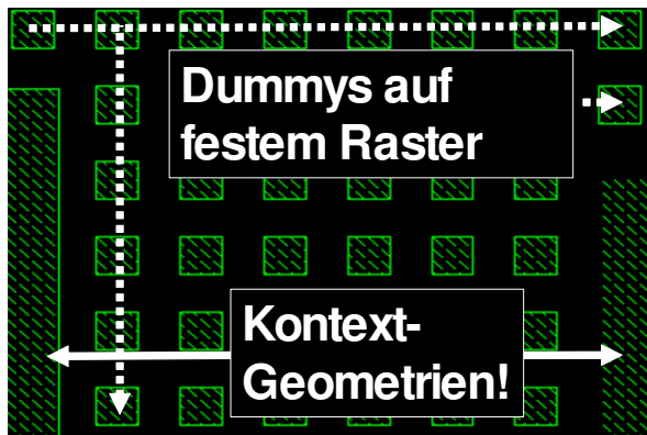
Abbildung 6. Layout-Ausschnitt erstellter Dummy-Geometrien einer Metallage.
