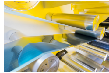
Abbildung 3. Herstellung einer Heliatek®-Solarfolie [16].
