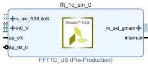
Abbildung 7. IP Integrator Symbol für FFT1.
