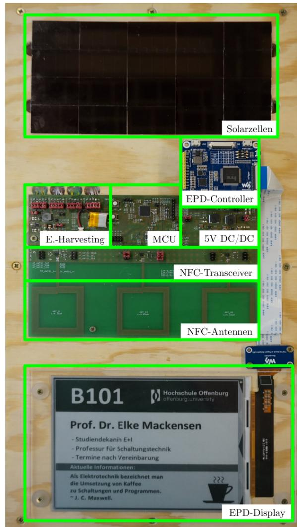
Abbildung 6. Implementiertes Funktionsmuster des energieautarken Türschildes.
